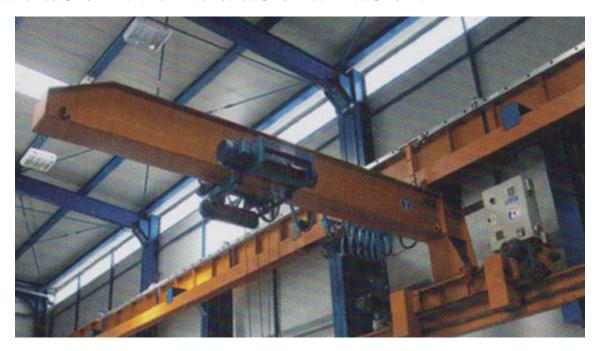
一、壁行起重机产品构成:壁行式起重机主要由悬臂主梁、横梁装置、上横梁装置、下横梁装置、升降机构、运行机构、限位装置及控制系统等组成。产品安装在由厂房立柱、垂直承载梁、水平承载梁组成侧面墙体上,实现对厂房单侧的物料搬运,和桥式起重机、旋臂起重机三者形成对车间的多层物料输送。 二、壁行起重机产品特点:1.在厂房立柱上安装起重机用轨道;2.起重机安装在厂房立柱的侧壁上,壁行式起重机安装在轨道上;3.壁行式起重机和桥式起重机、旋臂起重机等形成多层层吊装空间。制造壁行起重机生产壁行起重机,或称壁行式起重机,或壁行式悬臂起重机,生产厂家,南京高锐特起重机生产。
