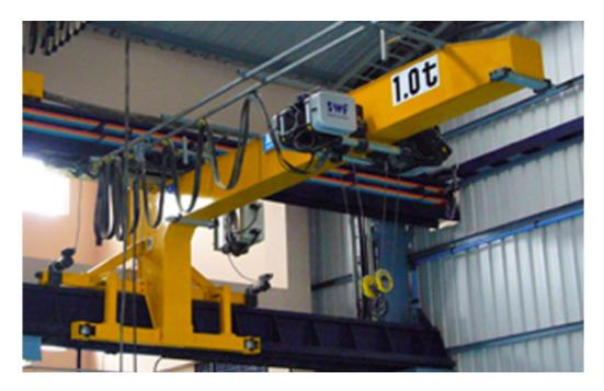
一、壁行起重机安全性与可靠性: 1. 大车、小车三合一电机防坠保护,防止意外坠落; 2. 防雨罩: 室外起重机配置起升机构、电控箱及驱动机构的防雨罩; 3. 声光报警装置; 4. 无线防撞装置; 5. 超载限制器; 6. 上下限位开关; 7. 端梁配置无论缘水平导向轮或双轮缘车轮、抗磨轴承、大车缓冲块、防脱轨端板。二、壁行起重机性能参数: 1. 起重量□500—20000kg□2□ 起升高度: 大于6m□3□跨度□4—30m□4□起升速度□5/1m/min双速; 或8/2m/min双速; 5. 小车运行速度□2-20m/min变频调速; 或4-40m/min□变频调速; 6. 大车运行速度□20m/min□或20/5m/min□或2-20m/min变频调速。
